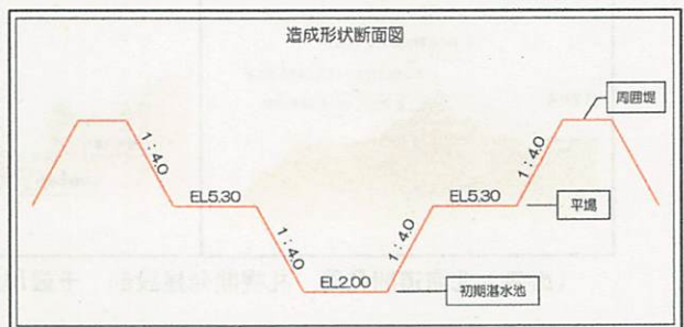
図-3 北島遊水地造成形状断面図(略図)
